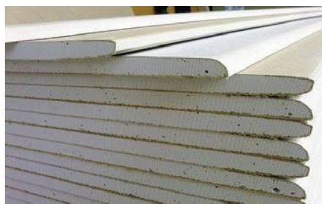
Slika 37 Presjek gipskartonskih ploča
