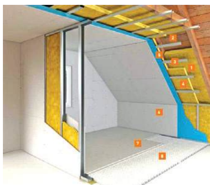
Slika 102 Obloga potkrovlja na metalnoj potkonstrukciji
