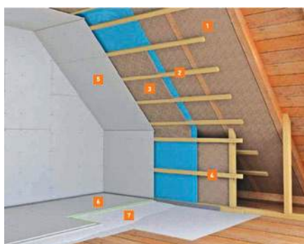
Slika 101 Obloga potkrovlja na drvenoj potkonstrukciji
