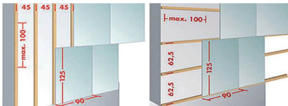
Slika 2-18 Potkonstrukcija od drvenih letvi položena okomito i vodoravno na zid [91]
