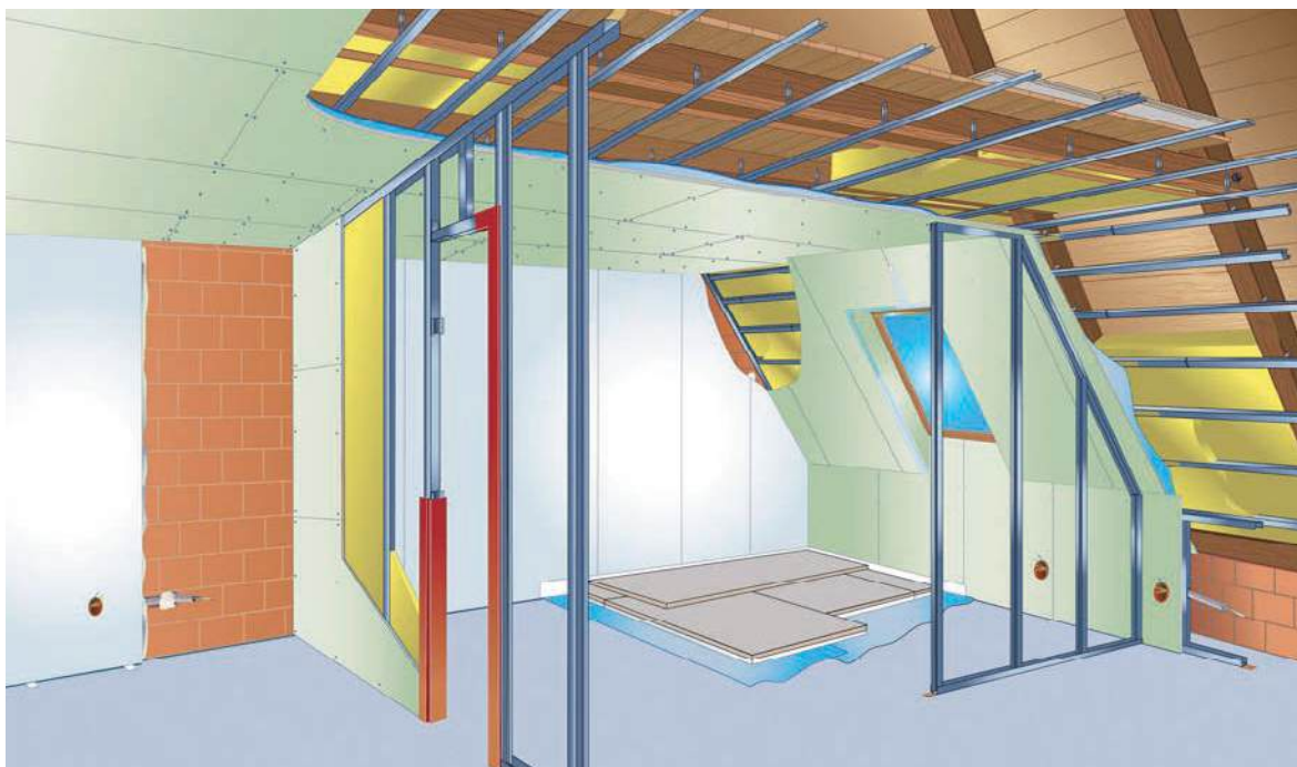
Slika 2-1 Sustavi suhe gradnje [82]
