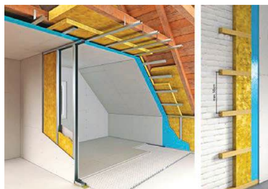
Slika 2-2 Zidni sustavi suhomontažne gradnje [83], [84]
