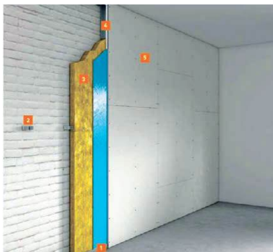
Slika 2-27 Postavljanje parne brane prije toplinske izolacije na vanjskome je zidu obavezno [100]
