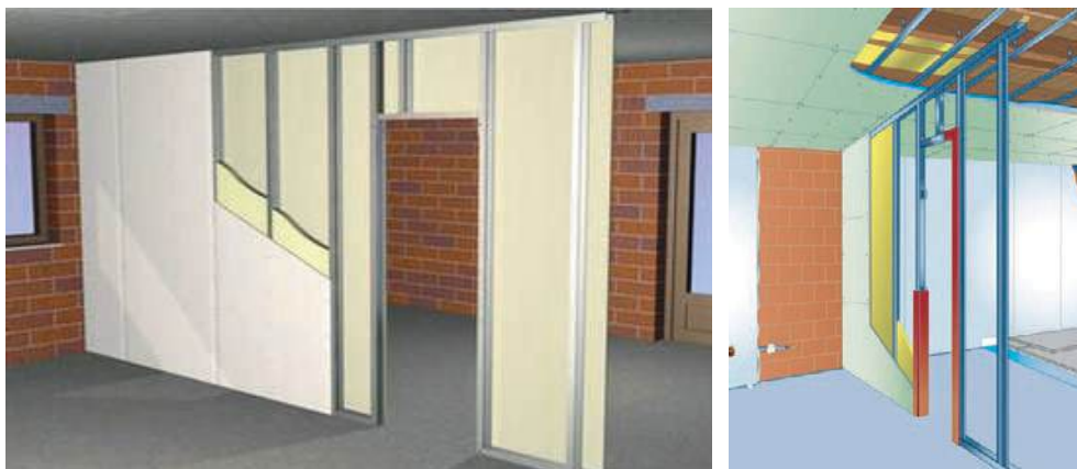
Slika 2-52 Vrata u pregradnom zidu [114], [99]
